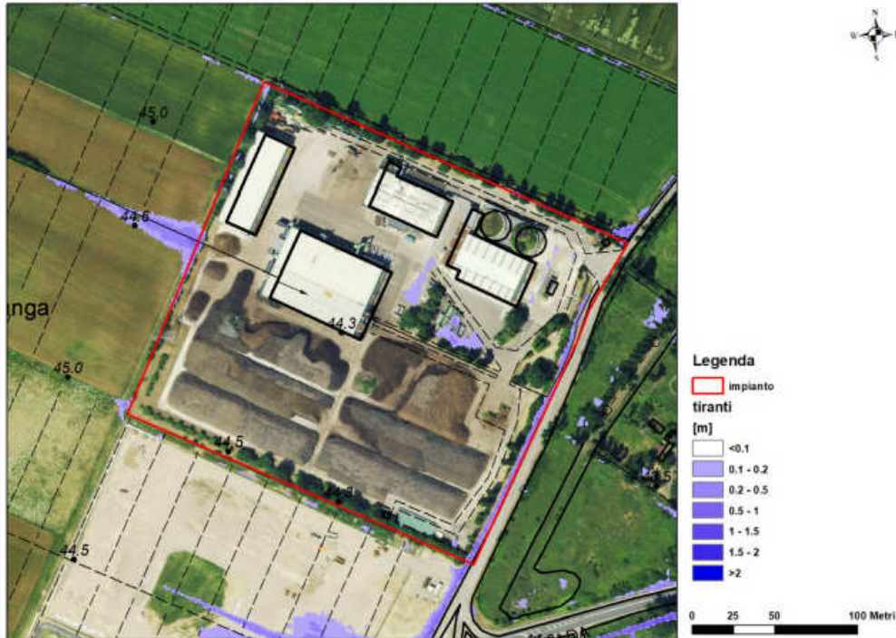
Figura 16- tiranti idrici di riferimento [m] mappatura all'interno dell'area impianto
